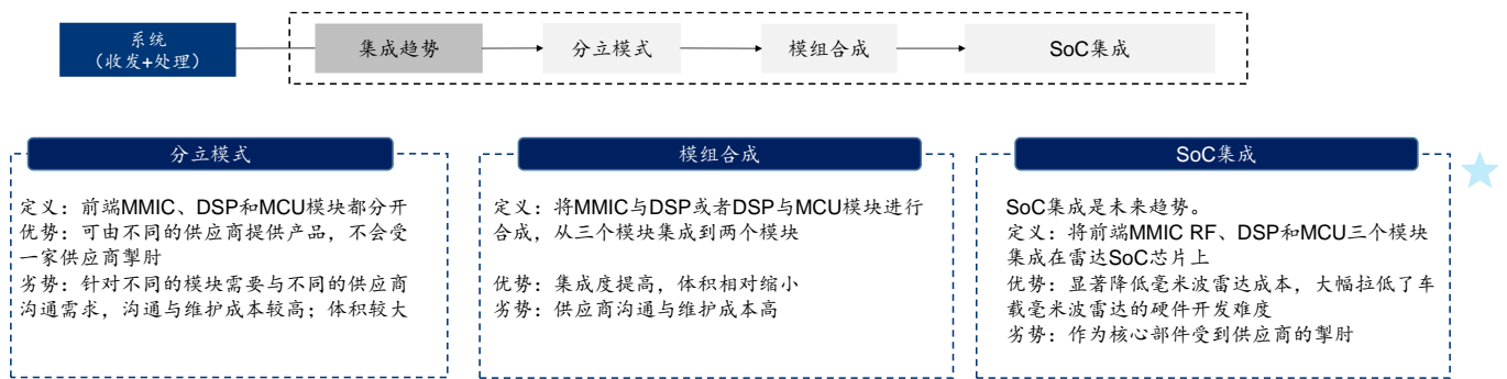
图表22：系统：分立-模块合成-SoC 集成
