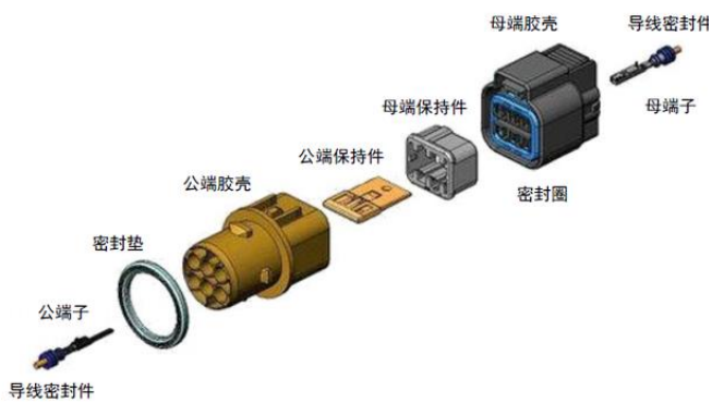
图 23: 汽车连接器一般结构
