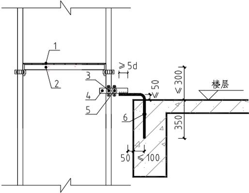
图 6.2.4-2 组合连墙件设置示意图
