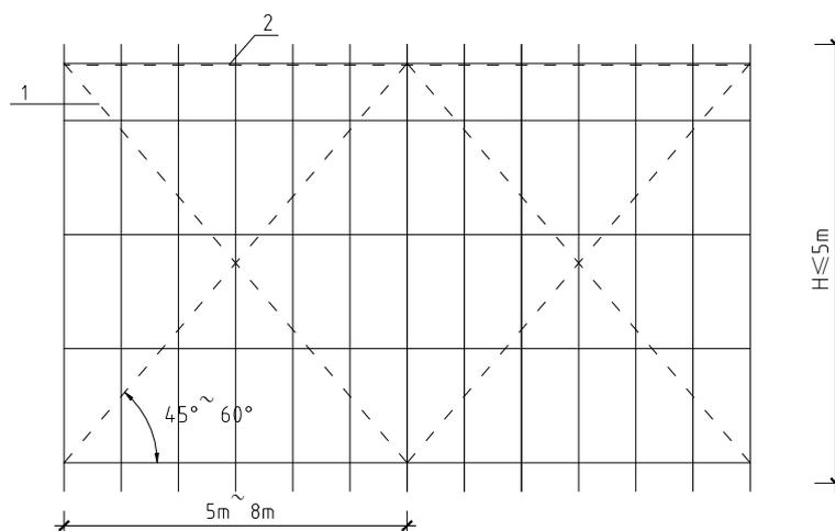
图 6.1.3-1 剪刀撑设置立面示意图
