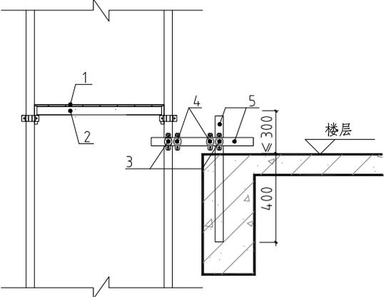
图 6.2.4-1 钢管连墙件设置示意图
