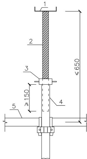
图 6.1.6 可调托座伸出顶层水平杆的悬臂长度
