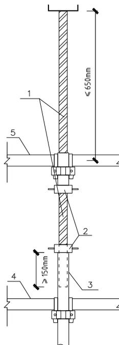
图 6.1.7 可调螺杆伸出顶层水平杆的悬臂长度
