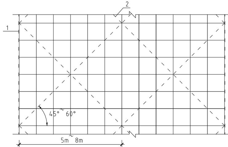
图 6.1.3-2 剪刀撑设置平面示意图
