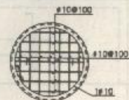
混凝土井盖配筋图
