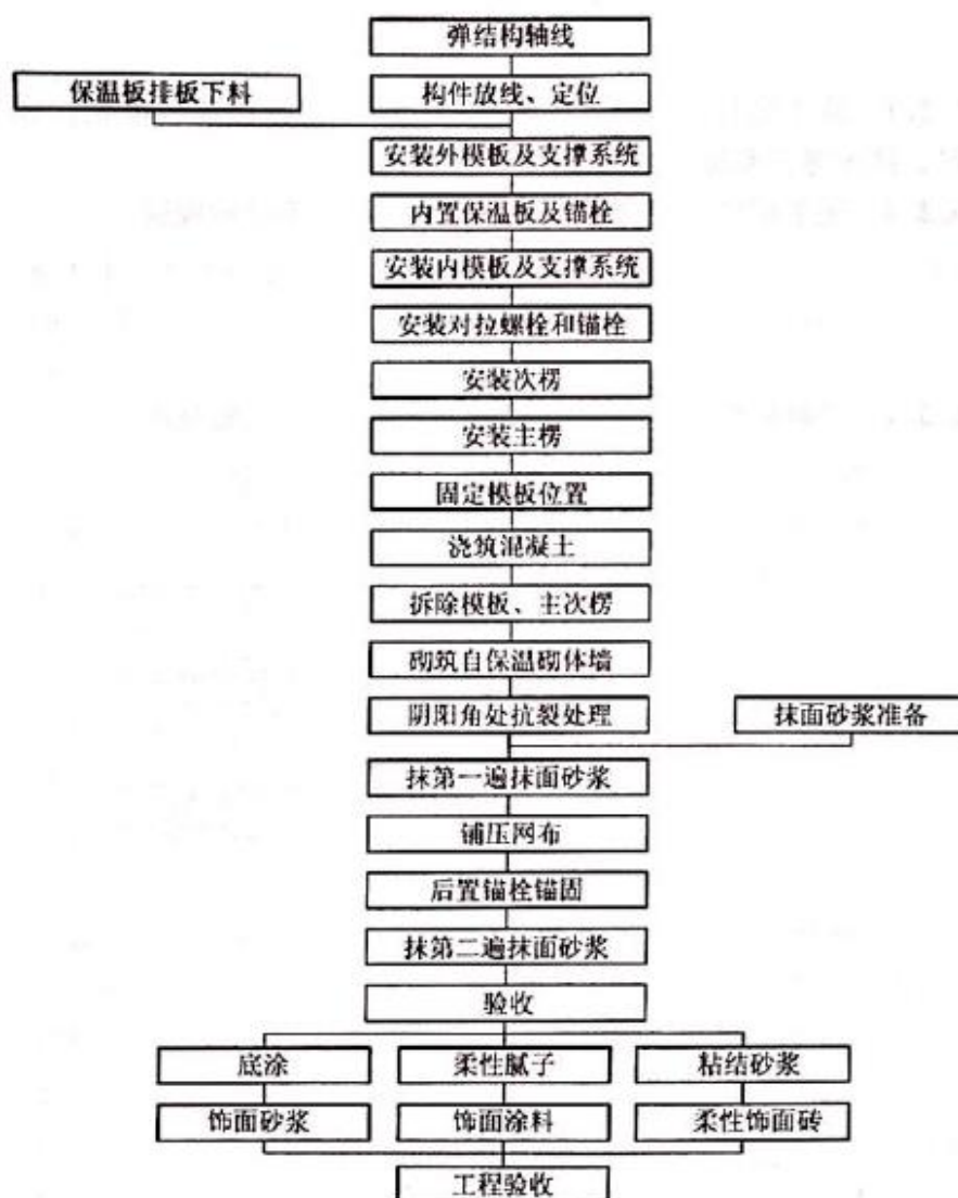
图 6.3.2 复合材料保温板现浇外墙外保温系统施工工艺流程
