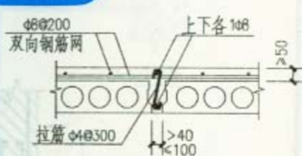
4 预制板板缝配筋构造
