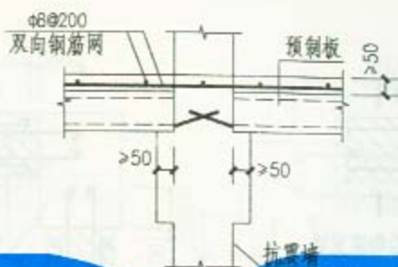
2 抗震墙边框架搁置预制板构造
