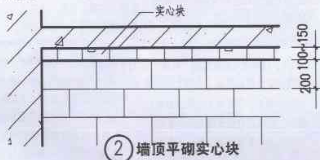
(2) 最上一皮砌块距梁100mm左右时，可用实心块平砌，用砂浆捻实。
