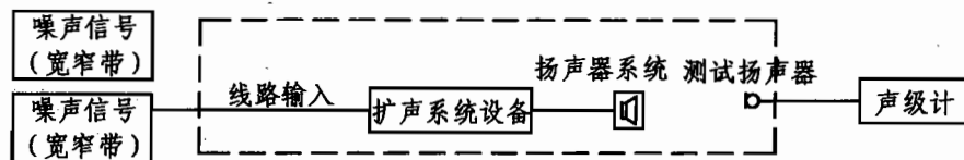
图8-3 电输入法测量原理框图
