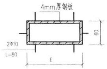
穿圈梁预埋方管平面图
