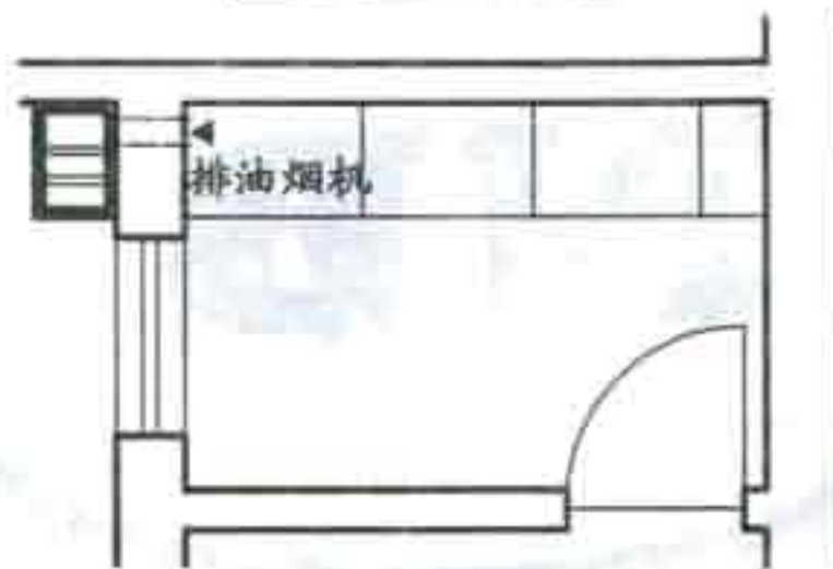
右进风口通风道在 厨房外布置示意图
