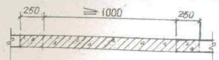
④ 隔墙门洞过梁平面
