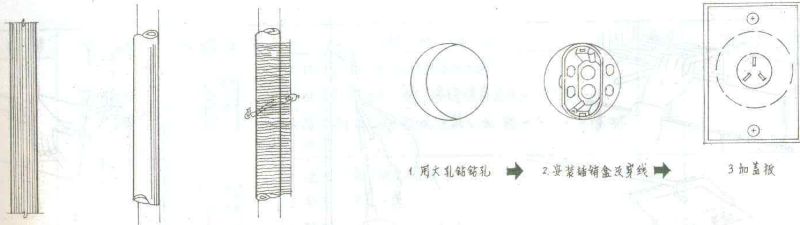
1 用线槽工具在墙上线槽 → 2 埋管线 → 3 墙上钉钉用铁丝扎牢固定并钉100宽镀锌铁丝网
