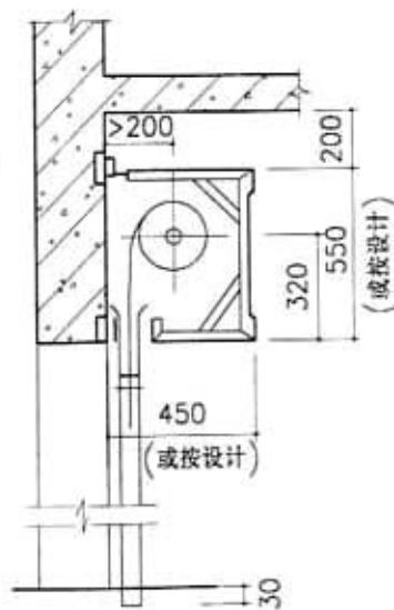
墙体侧面安装 三面罩壳
