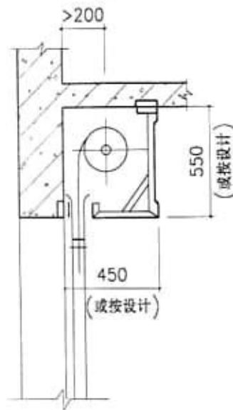
墙体侧面安装 二面罩壳
