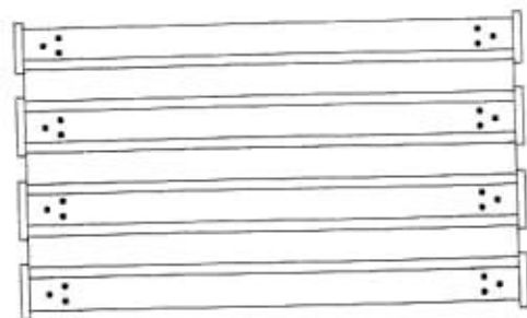
钢、铝质板状门帘:坚固,密封,抗风压性能较好,代号“A”
