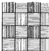
水泥地面机压纹路
