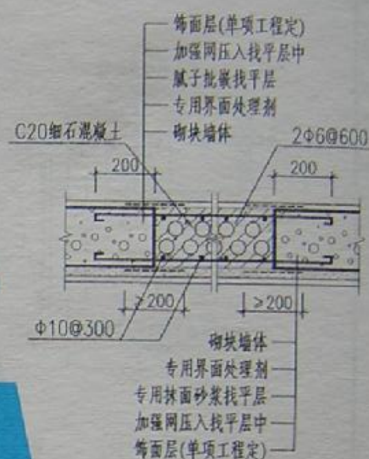
3 密集暗埋管线墙体加强示意
