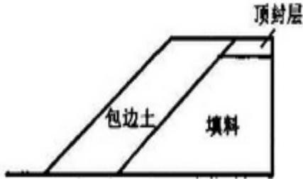
图 8.1.1 淤泥路基典型路基断面图
