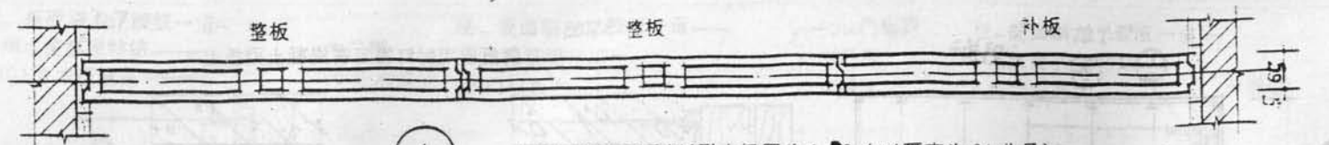
① 单层板墙平面示例 (耐火极限为 1.30 小时隔声为 34 分贝)
