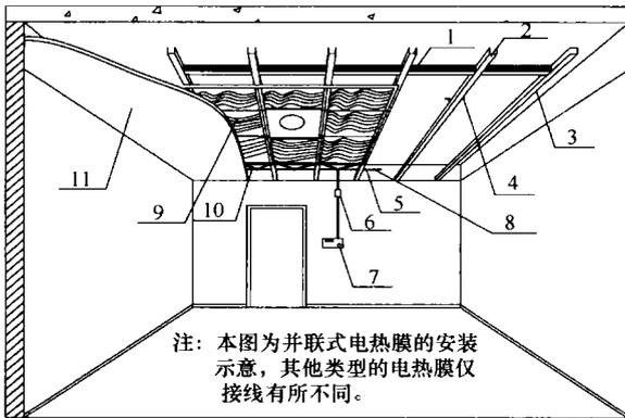
图 2 电热膜棚面供暖的棚面构造示意图
