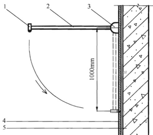
图 10.0.7 摆锤法检测垂直立面防水层柔性示意图
