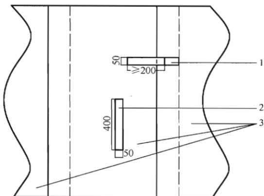
图 9.0.4 剥离强度试件
