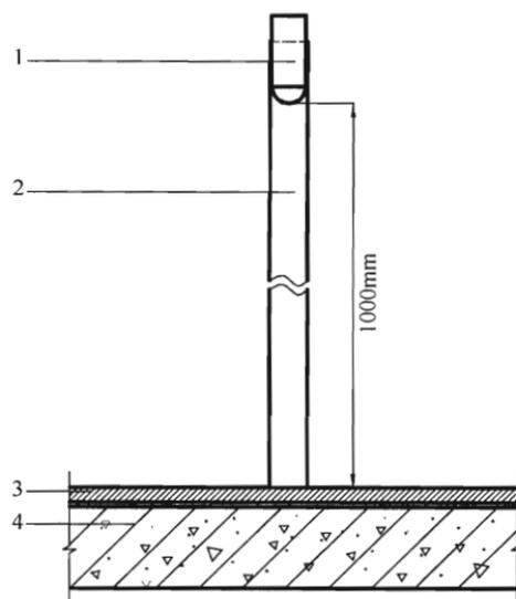
图 10.0.6 落锤法检测水平面防水层柔性示意图
