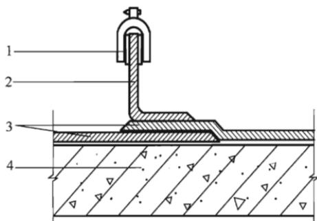
图 9.0.6-2 卷材防水层接缝剥离
