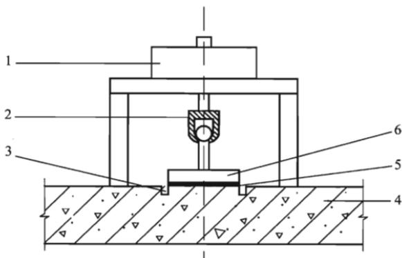
图 6.0.4 基层表面正拉粘结强度检测示意图
