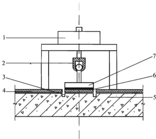
图 7.0.5 防水层粘结强度检测示意图
