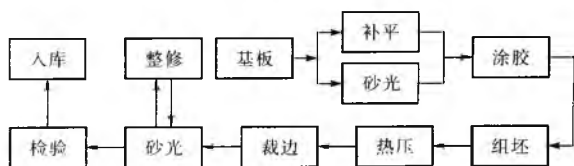
图 2 再生木模板生产工艺流程图
