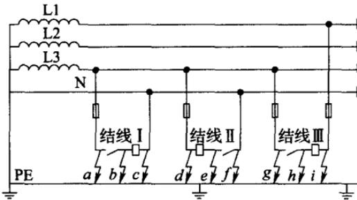
图 1 控制回路结线示例图
