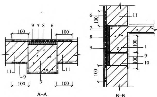
图 5.3.8 自保温砌块墙体与钢筋混凝土梁、柱、墙交接面抗裂加强处理示意
