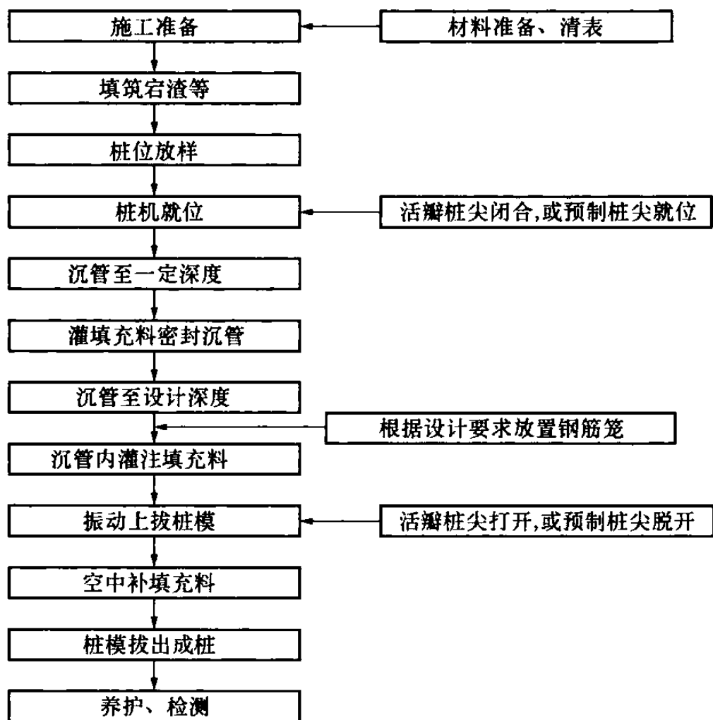
图4 现浇X形桩施工工艺流程
