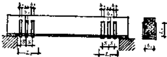
附图 1.2 梁端增设 U 型箍板锚固
