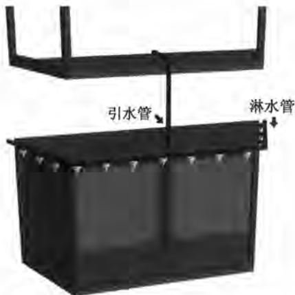
图 A.0.1 外窗（墙）淋水试验示意
