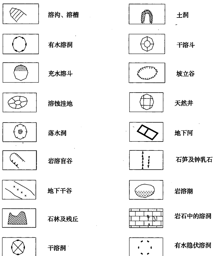
图 B.0.6-3 岩溶地貌形态图例
