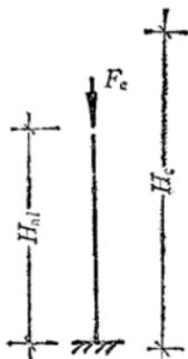
图 4·2·3—2 正在提升状态时柱的计算简图
