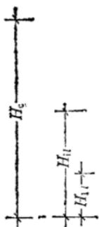
图 4·2·3—1 搁置状态时柱的计算简图
