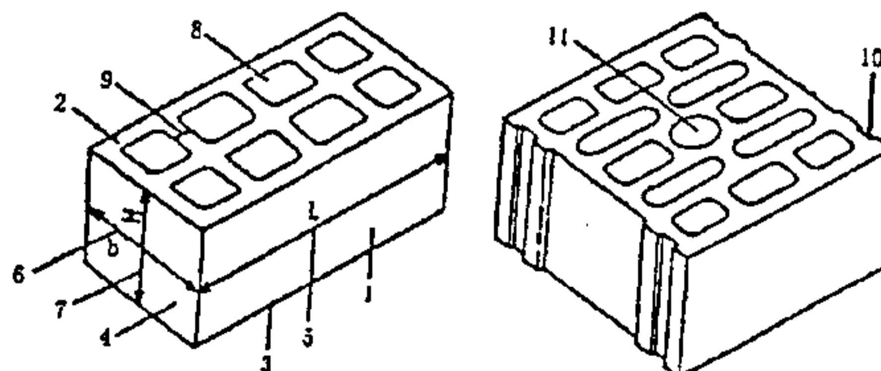
1——条面；2——坐浆面(外壁、肋的厚度较小的面)；3——铺浆面(外壁、肋的厚度较大的面)；4——顶面；
