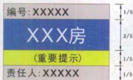
图 1 供配电室和消防用房标识示意
