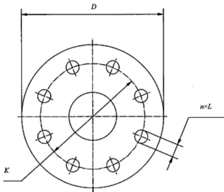
图 A.1 PN2.5、PN6、PN10 和 PN16 法兰连接尺寸示意图
