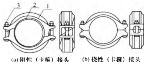
图3 钢管沟槽式连接示意图
