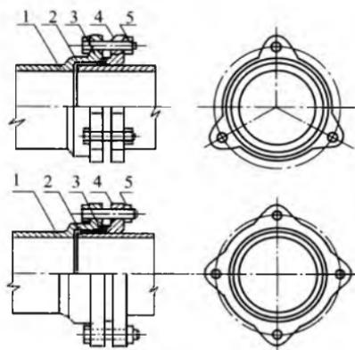
图2 铸铁管法兰机械式接口连接示意图
