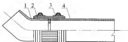
图1 铸铁管卡箍式接口连接示意图
