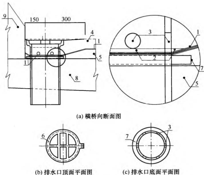
图 4.4.5-2 圆形排水口安装示意
