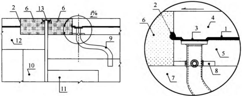
图 4.4.4 伸缩缝槽边的渗水漏管示意
