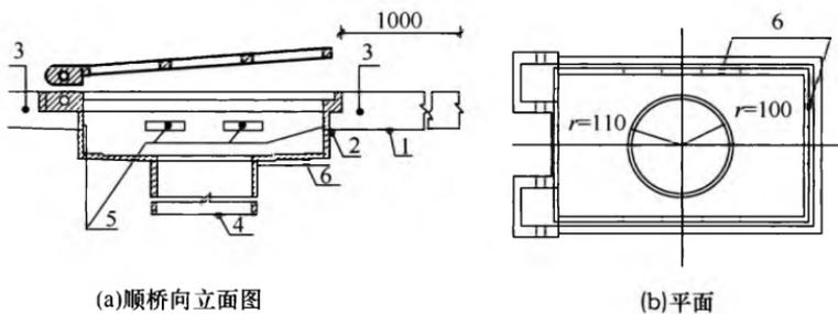
图 4.4.5-1 矩形排水口安装示意
