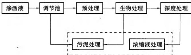
图 4.2.1 常规工艺流程
