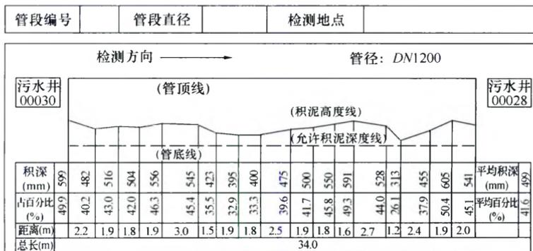
图 3 排水管道沉积状况纵断面图示例
