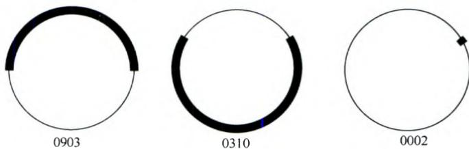
图 1 缺陷环向位置时钟表示法示例
