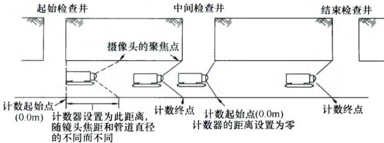
图 2 计数器归零的补偿设置方法示意图
