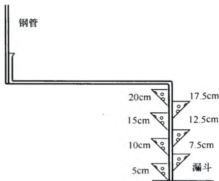
图 4 Z 字形量泥斗构造图
