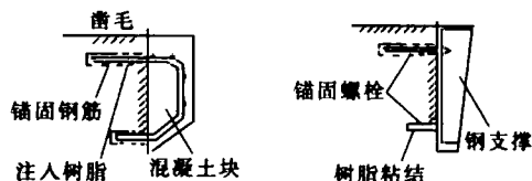
图 18 采用支座支承上部结构时的托架支撑
