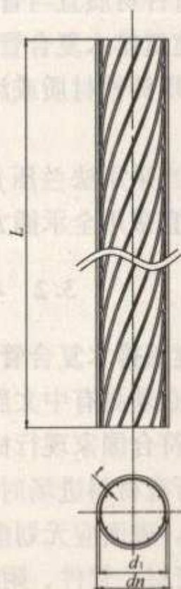
图 3.1.4-2 加强型钢塑复合螺旋管
