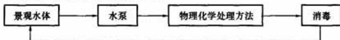
图 1 物理化学处理流程图
