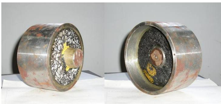
图 2 同轴剪切试验试件
