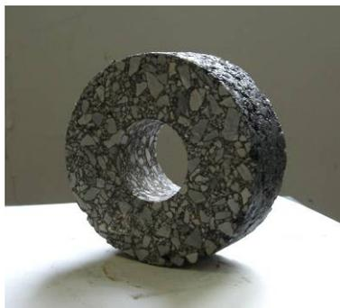
图 1 试验用中空圆柱体试件
