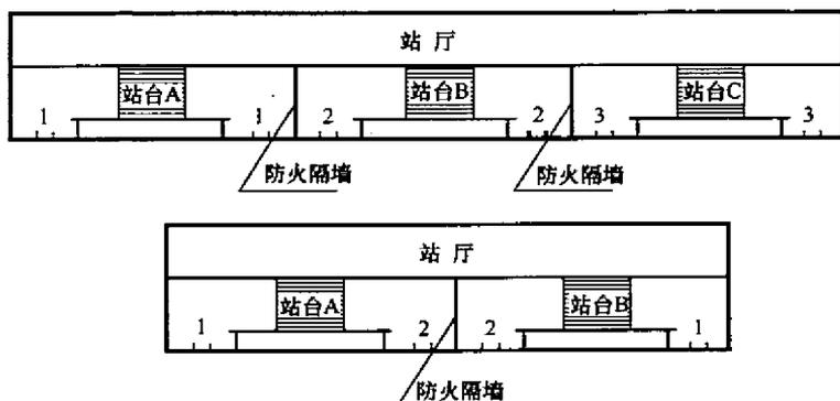
3 多线点式换乘车站，是指二线站台之间的“+”、“T”、“L”型换乘，三线站台之间“△”、“++”、“□”、“Y”、“H”等形式换乘，以及站厅之间的通道换乘。它们之间的换乘梯和换乘通道均应设防火隔断，仅在通道（梯）两端洞口处设防火卷帘，分线控制。换乘通道或换乘梯不能作为火灾工况下的安全疏散口，发生火灾时由火灾车站侧落下防火卷帘。
