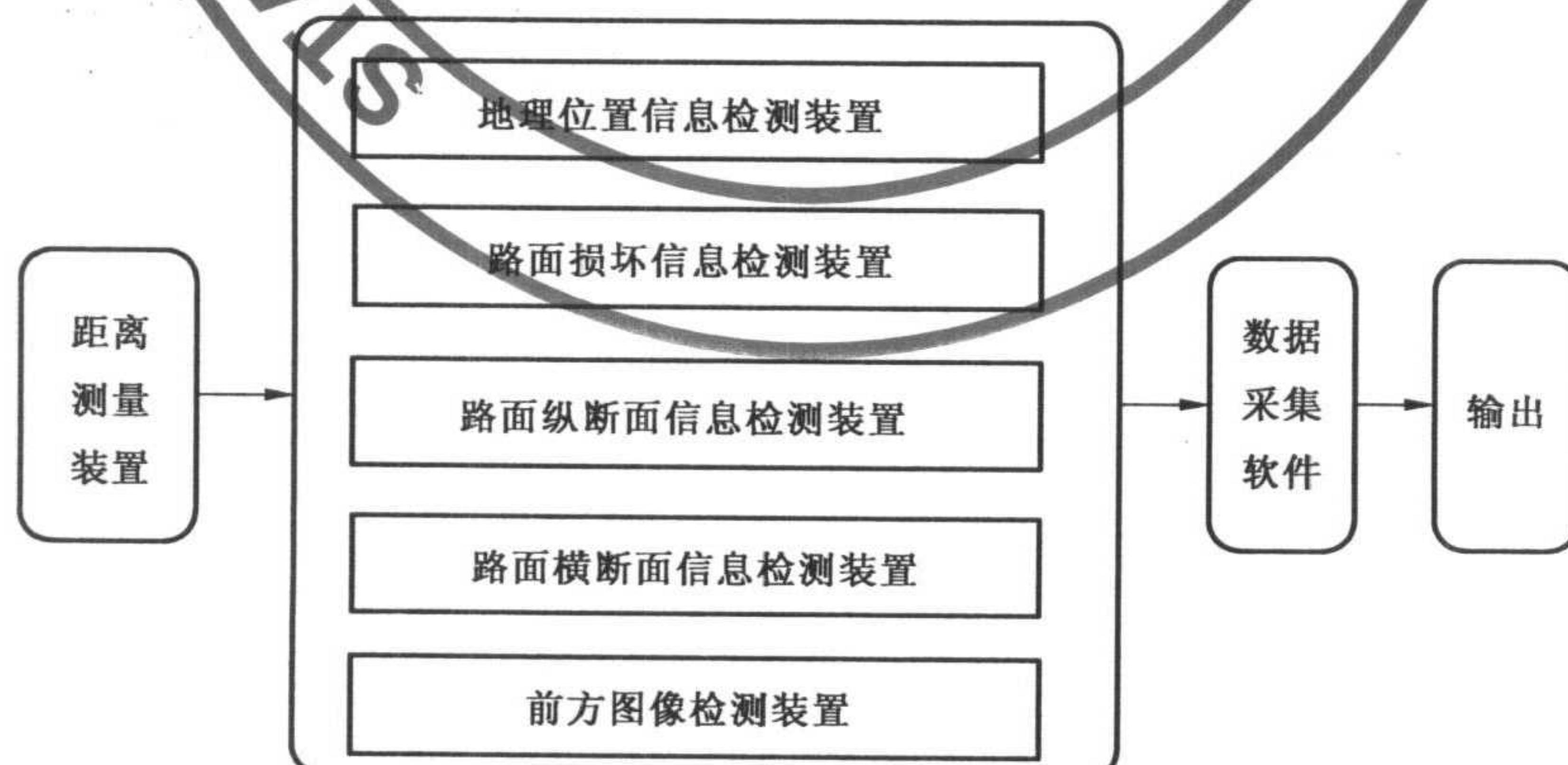
图 1 检测设备组成示意图
