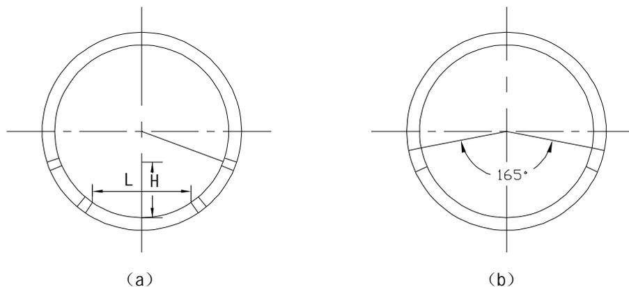
图5.3-2 带槽孔排水管的圆孔和槽口布置
