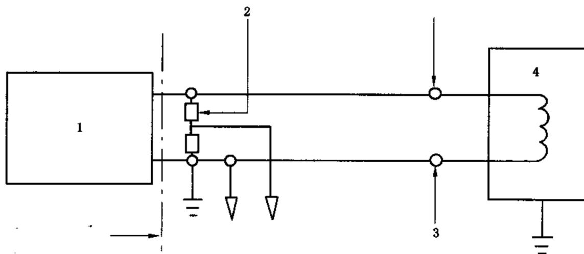
图 5 高压脉冲试验电路
