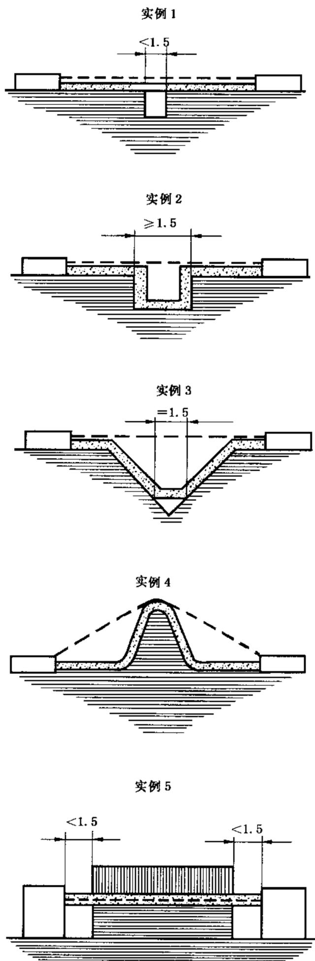
图 3 测定爬电距离和电气间隙的示例
