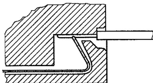
图 4b) 不允许的弹簧片无螺纹接线端子示例
