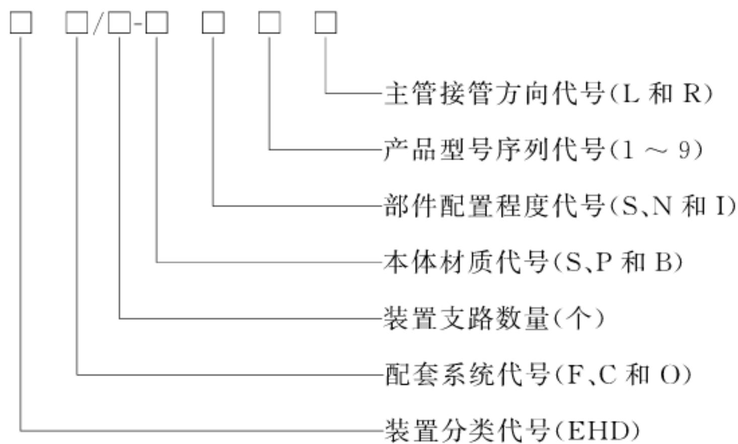
示例：末端采用风机盘管空调机系统，对接 5 台风机盘管，本体材质采用不锈钢材料，按照简配型进行配置，产品型号序列为第二代的第二次修改，主管接管方向为左式的空调末端冷热水分配及柔性多联装置，标记为：
