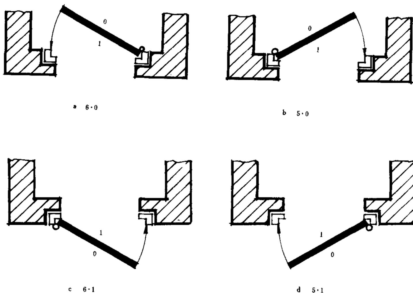
图 3 开关方向和标志面
