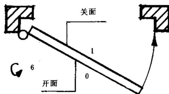
图2 逆时针方向关闭“6”
