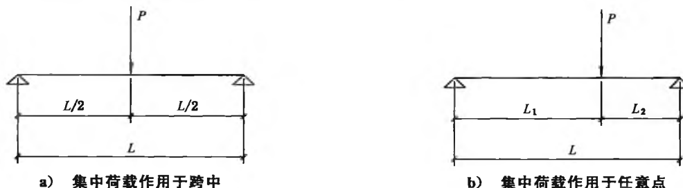
图 B.12 简支梁承受集中荷载示意图
