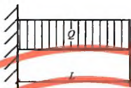
图 B.13 悬臂梁承受均布荷载示意图
