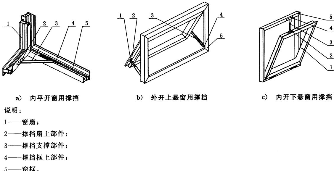
图 1 撑挡示意图
