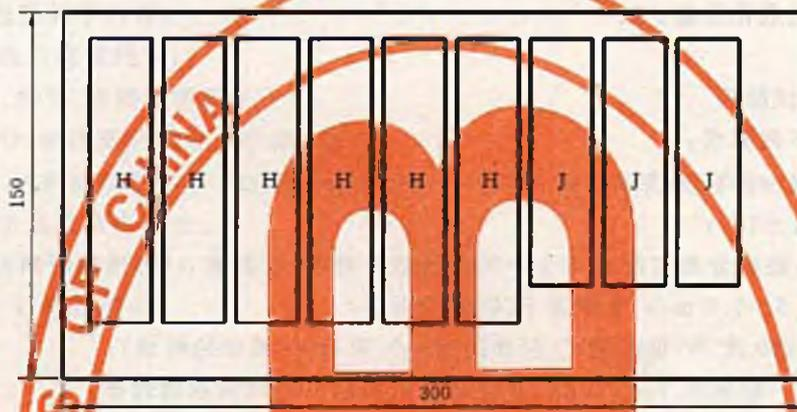
图 3 防水涂料的取样图
