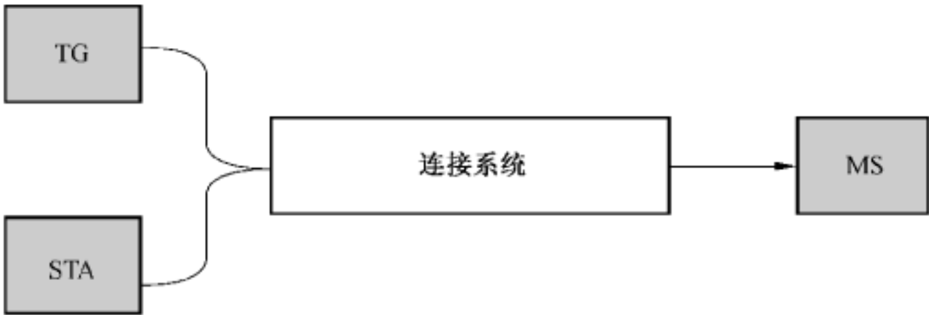
图 1 热分析-质谱联用装置组成示意图
