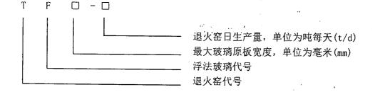
示例:玻璃原板宽度为 3.5 m, 退火窑标准生产能力为 500 吨/天的浮法玻璃退火窑可标记为: 浮法玻璃退火窑 JC/T 604-2013 TF 3500-500
