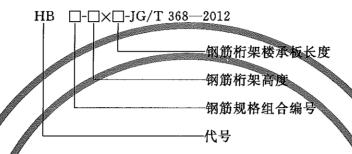
注 1. 钢筋桁架楼承板的长度(L)为上下弦钢筋长度。单位为米(m),见图 1。
