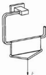
图 5 毛巾环试验方法示意
